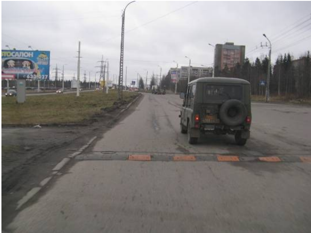
Abbildung 23: Straßenschwelle vor Fußgängerquerungen (Foto: S.Schwarzbach)
