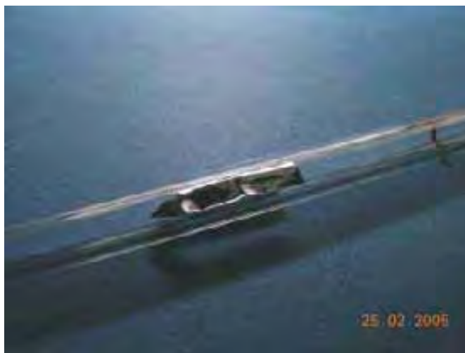
Abbildung 4-47: Direkte Thermodesorption - links: ausgeschnittene Probe (Silikon) mit Aluminiumfolie; rechts: in ein TDS-Rohr eingebrachte Probe
