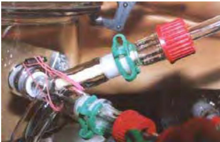
Abbildung 3-10: Probenahme mit PU-Schäumen an einer 23-l-Kammer mit Probenkörpern
