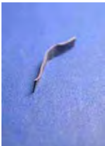
Abbildung 4-47: Direkte Thermodesorption - links: ausgeschnittene Probe (Silikon) mit Aluminiumfolie; rechts: in ein TDS-Rohr eingebrachte Probe
