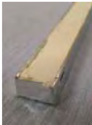
Abbildung 3-1: Einbringen von einer Dichtmasse in ein Aluminium-U-Profil
