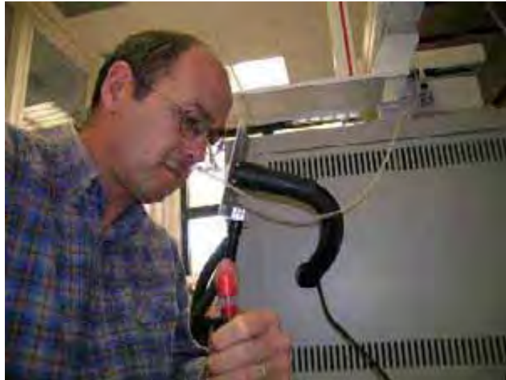
Abbildung 4-44: Ein Proband riecht am Eluat des Chromatographen (gut zu erkennen sind der Riechtrichter und das Potentiometer für die Antworten)
