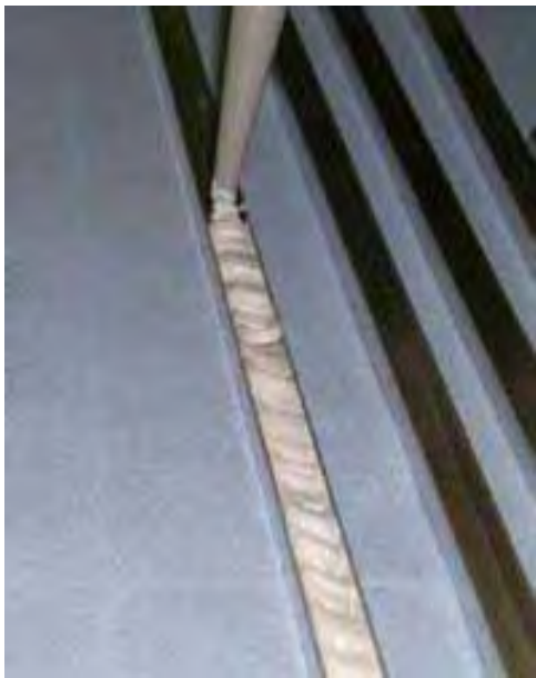
Abbildung 3-1: Einbringen von einer Dichtmasse in ein Aluminium-U-Profil
