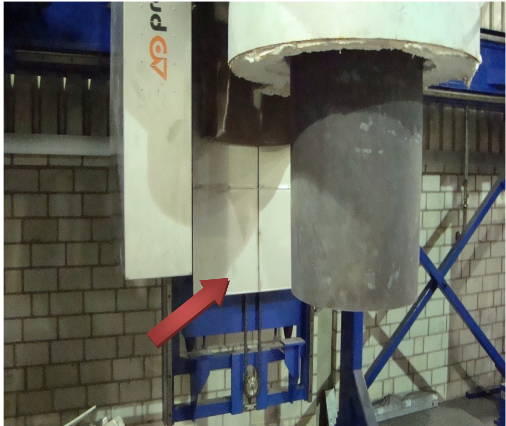
Abbildung 24: Anbau von Hitzeschutzblechen zum Schutz der Kette und Führungen
