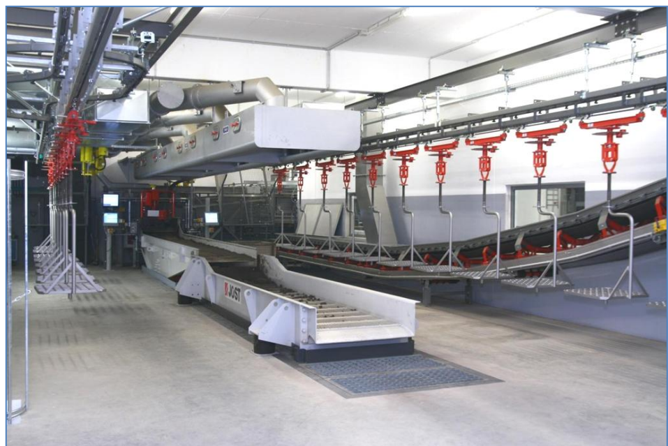
Bild 2.4: Vibrationsrinnen zur Gussteilentnahme und zum gründlichen Abreinigen des Sandes von der Gusstraube
