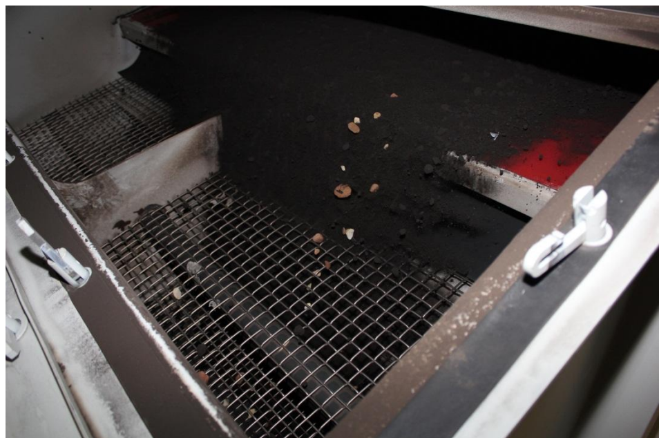
Bild 2.5 b: Mehrdeck-Sieb: Blick in das geöffnete Aggregat Mehrere übereinander liegende Siebe unterschiedlicher Maschenweite bewirken eine sehr effektive Vorreinigung des Formstoffes Deutlich erkennbar sind die enthaltenen hellen Kernsandreste
