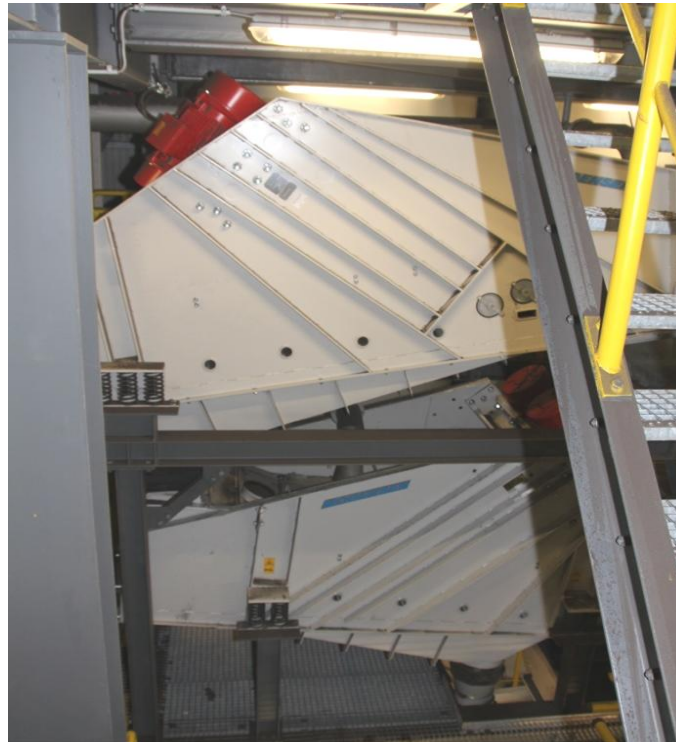
Bild 2.6 a: Flachsiebe mit unterschiedlicher Maschenweite
