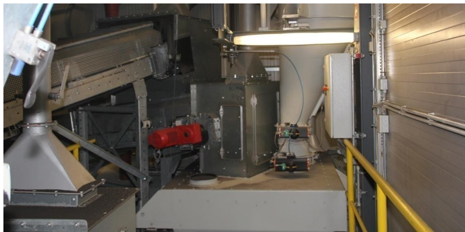
Bild 2.9: Präzisions-Wiegesystem für den Altsand
