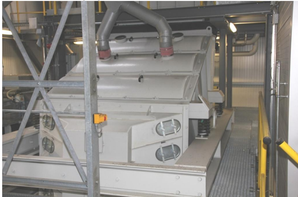
Bild 2.5 a: Mehrdeck-Sieb integriert mehrere Siebstufen in einem Aggregat
