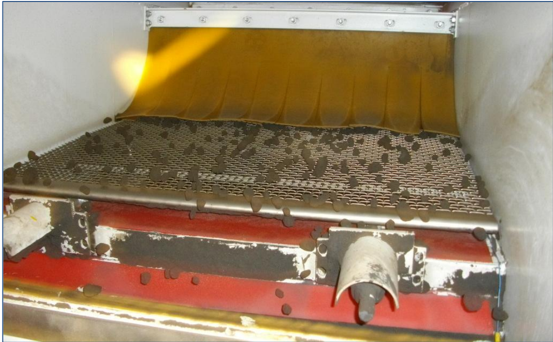
Bild 3.5: Knollenbildung bis zur letzten Siebstufe – dadurch großer Sandverlust
