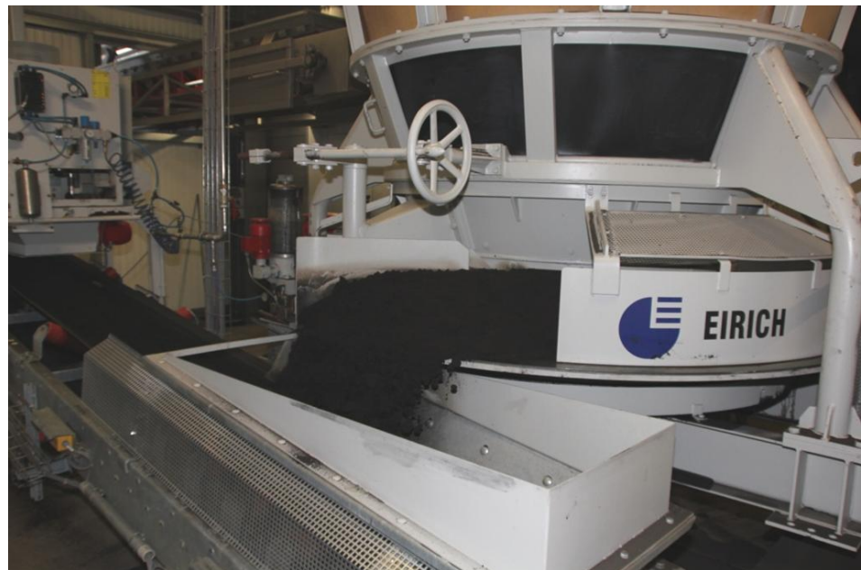
Bild 2.12: Telleraufgeber: Fertigsandaufgabe auf den Bandförderer
