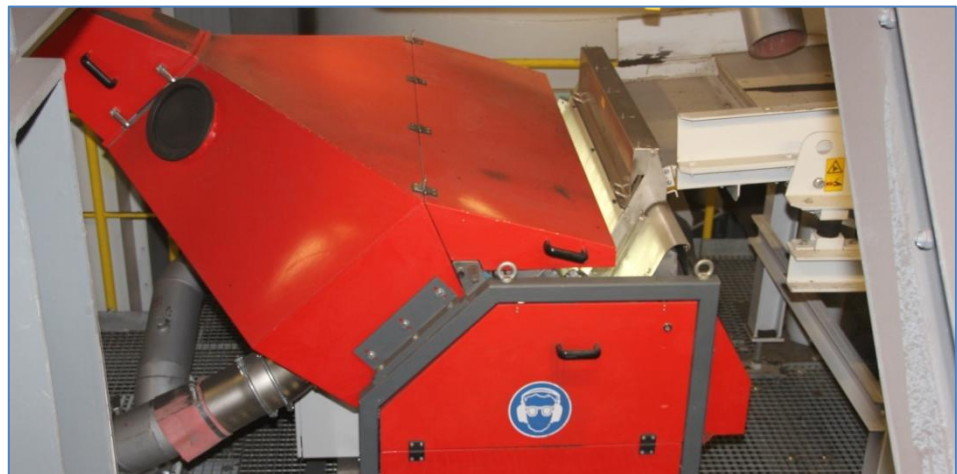
Bild 2.7a: MikroSort-Anlage zur optischen Trennung von Verunreinigungen aus dem Altsandstrom
