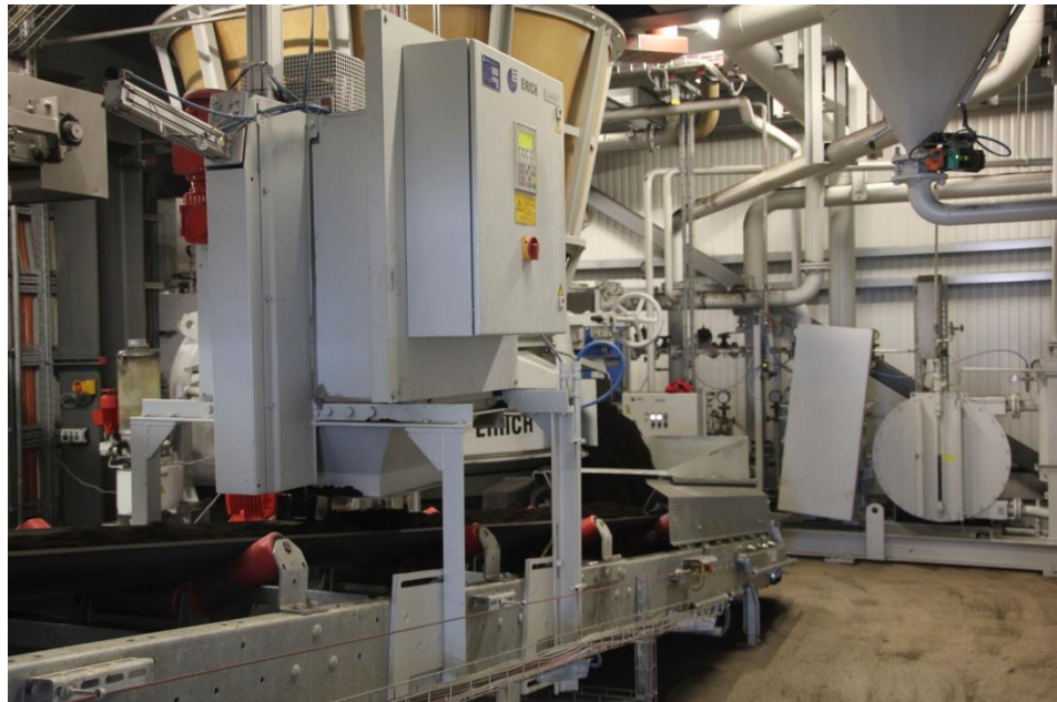
Bild 2.13: QualiMaster AT1 entnimmt aus dem Fertigsandstrom Sandproben für die Online-Analyse der technologischen Eigenschaften
