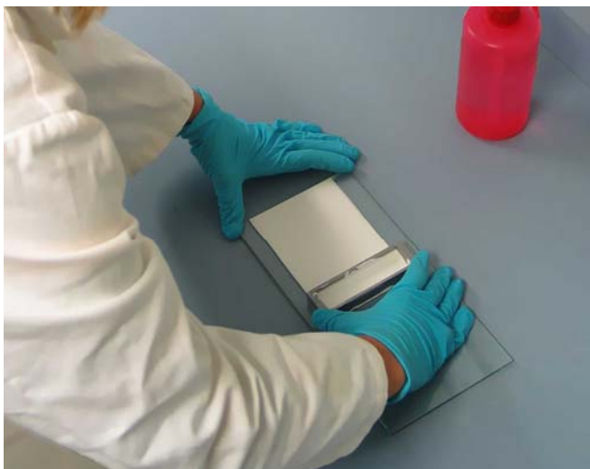
Abbildung 3-5. Beschichtung einer Glasplatte mittels Rakel.
