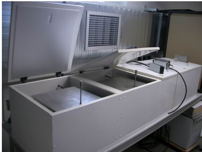
Abbildung 3-4. Blick auf zwei 23,5 L Edelstahlkammern, die sich jeweils in einer separaten Box befinden.
