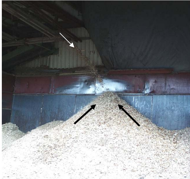
Abbildung 5: Probenentnahme am Hackerauswurf
