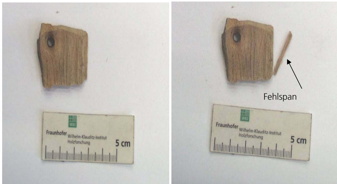
Abbildung 13: Typisches Bruchverhalten von Hackschnitzeln aus Laubholz (hier: Buche)
