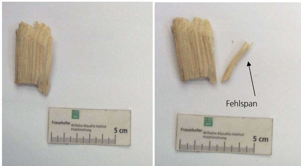
Abbildung 14: Typisches Bruchverhalten von Hackschnitzeln aus Nadelholz (hier: Fichte)
