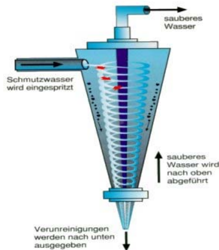
Abbildung 10: Schematischer Aufbau eines Hydrozyklon
