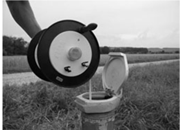
Abb. 1a: Grundwassermessstelle Abb. 1b: Ablesung mit Lichtlot
