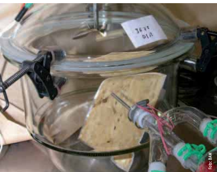
Emissionsprüfung: Kammer mit einem Volumen von 20 Litern (Exikator) mit der Materialprobe eines Holzwerkstoffes
