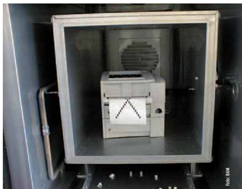
Emissionsprüfung: Kammer mit einem Volumen von einem Kubikmeter mit einem Drucker
