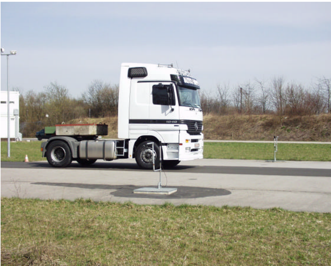
Abbildung 2: Geräuschmessung MB Actros, Reifengröße 315/80 R22,5
