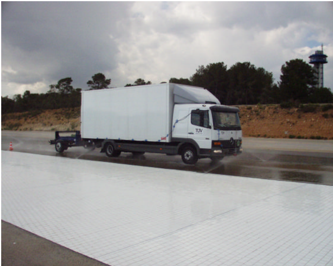
Abbildung 3: Nassbremsung mit Versuchsanhänger, Reifengröße 215/75 R17,5
