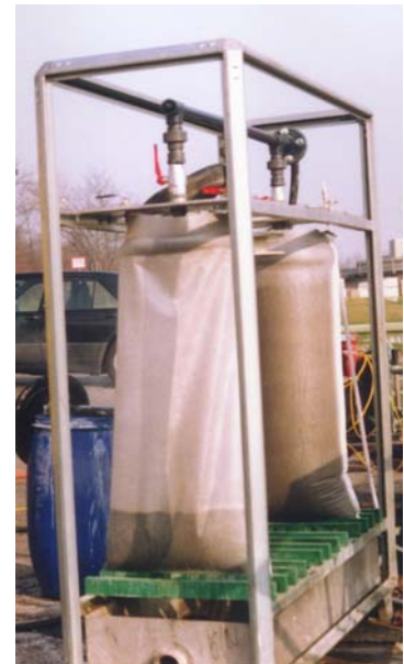
Bild 9.2: Absackvorrichtung der MAP-Pilotanlage Zentratwasserbehandlung der Firma NALVA
