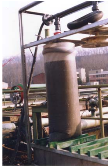
Bild 9.2: Absackvorrichtung der MAP-Pilotanlage Zentratwasserbehandlung der Firma NALVA
