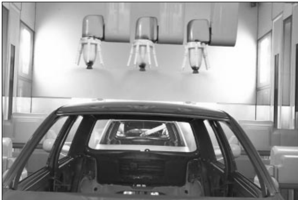
Abbildung 2-6: Vollautomatisierter Decklackiervorgang für Dach und Seiten [GRUBER 2001]
