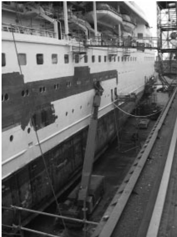
Abbildung 3-2: Schiffsentlackung mittels Hochdruckwasserstrahlen [PASTUCH, PALM 2001]
