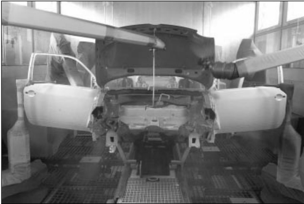
Abbildung 2-5: Decklackauftrag mit Robotern [GRUBER 2001]
