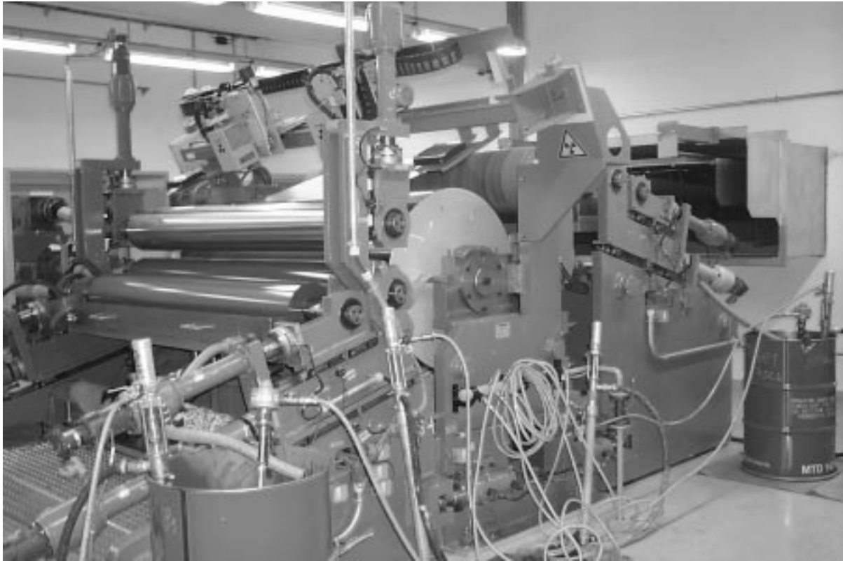
Abbildung 6-3: Abbildung einer Bandbeschichtungsanlage [Quelle Salzgitter]
