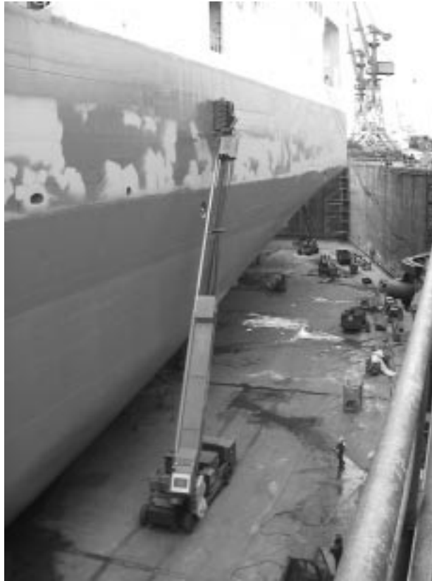
Abbildung 3-3: Automatische Beschichtungsanlage mit Oversprayabsaugung [PASTUCH, PALM 2001]
