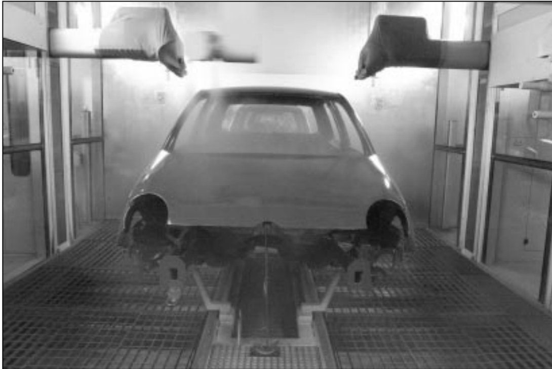
Abbildung 2-7: Automatisierter Auftrag von Metallic- bzw. Perleffektlacke im Spraymate-Verfahren [GRUBER 2001]
