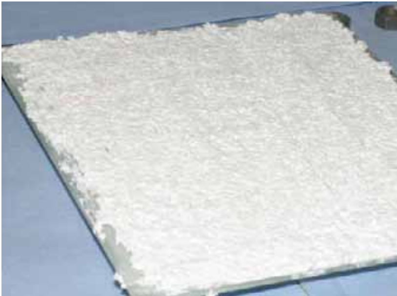
Abbildung 3-2: Beidseitig auf eine Glasplatte aufge- tragener Kunstharz- fertigputz
