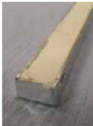
Abbildung 3-1: Einbringen von einer Dichtmasse in ein Aluminium-U-Profil
