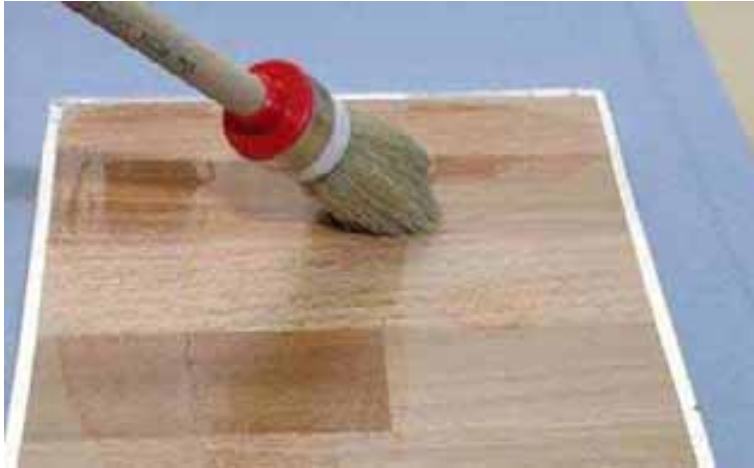
Abbildung 3-6: Pinselauftrag eines Lackes auf ein Holzträgermaterial
