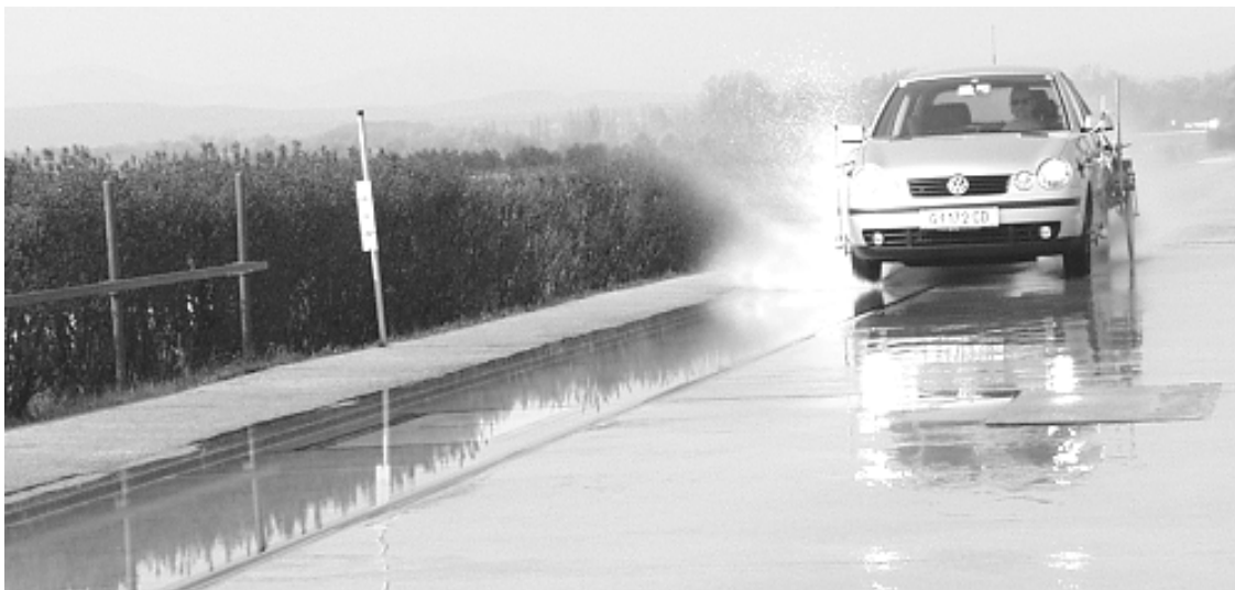
Abb.3: Testfahrzeug während Aquaplaningtest
