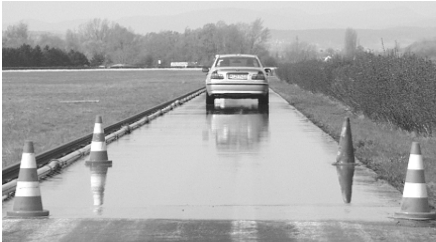
Abb.4: Testfahrzeug auf bewässerter Bremsstrecke
