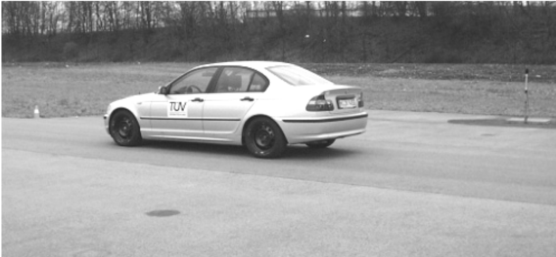
Abb.2: Testfahrzeug auf Geräuschemessstrecke
