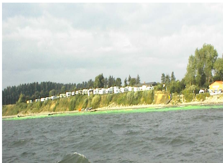
Abb. 38 Ausbreitung von Uranin am 19.09.2001; Aufnahme N. Robbe, Optimare
