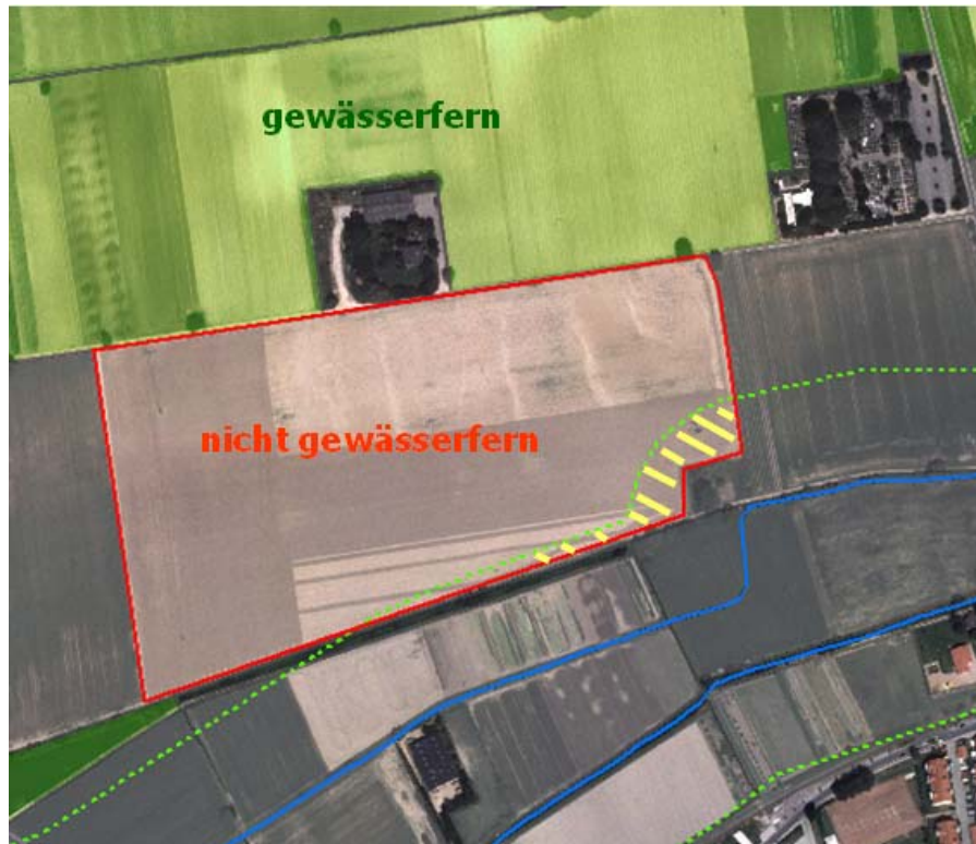
Abbildung 2.13 Grenzfälle - landwirtschaftliche Flächen, die sich nicht vollständig in einer Entfernung von 75 m bzw. 150 m befinden. Der expositionsrelevante Flächenanteil ist durch die Schraffur gekennzeichnet
