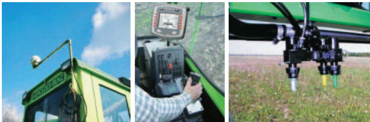
Abbildung 2.10 Elemente der GIS-basierten Pflanzenschutzausbringung
