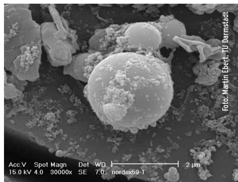
Rasterelektronenmikroskopische Aufnahme von Flugasche (Eisenoxid) mit Rußablagerungen.
