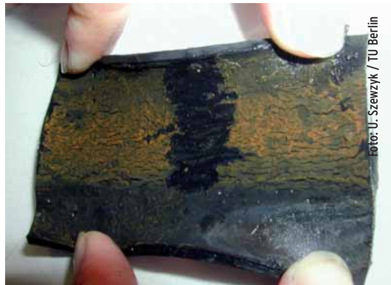
Bakterienwachstum (Biofilmbildung) auf Gummimaterial aus der Trinkwasserinstallation.
