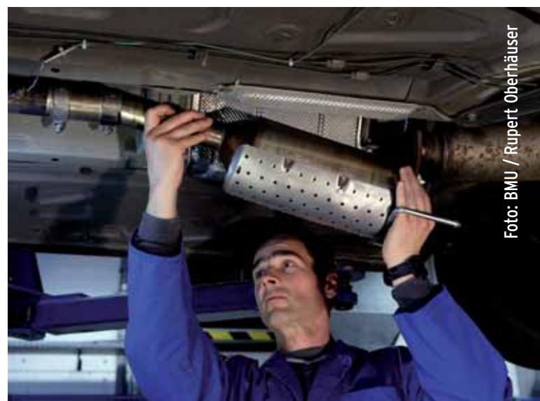
Diesel-Pkw: Nachrüstung mit Partikelfilter ist machbar.
