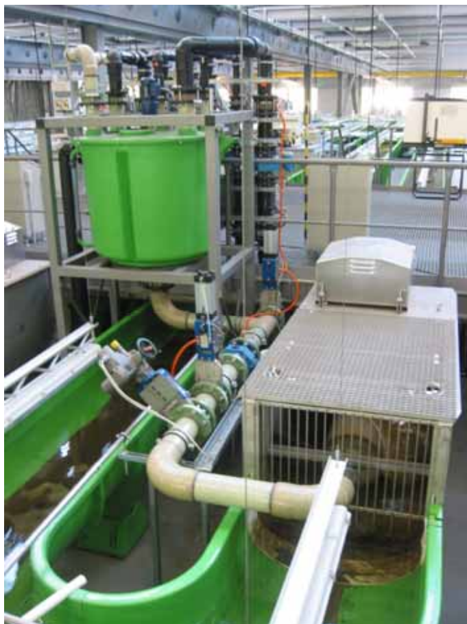
Abb. 9: Applikation von Metazachlor in den Rinnen mit den fest installierten Mischbehältern (Quelle: Autoren)
