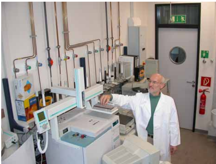
Abb. 11: Analyse von Metazachlor und Metabolite im Gaschromatographie-Labor (Quelle: Autoren)
