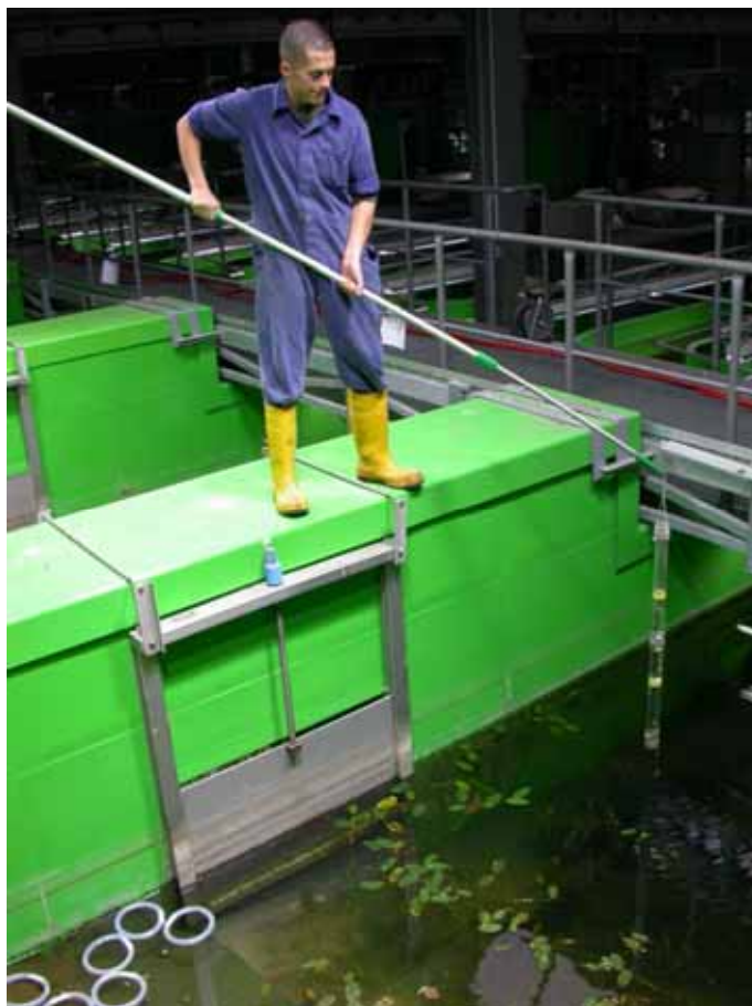
Abb. 19: Zooplanktonprobennahme mit speziellem Planktonplexiglasrohr (Quelle: Autoren)
