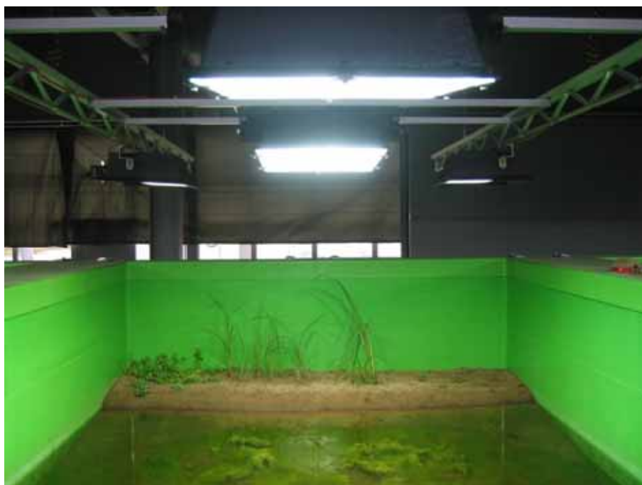
Abb. 80: Lampengestell über einem Teich in der Halle mit 2 x 2000 W HQI-Leuchten (Mitte) sowie den beiden 400 W HQI-Leuchten.
