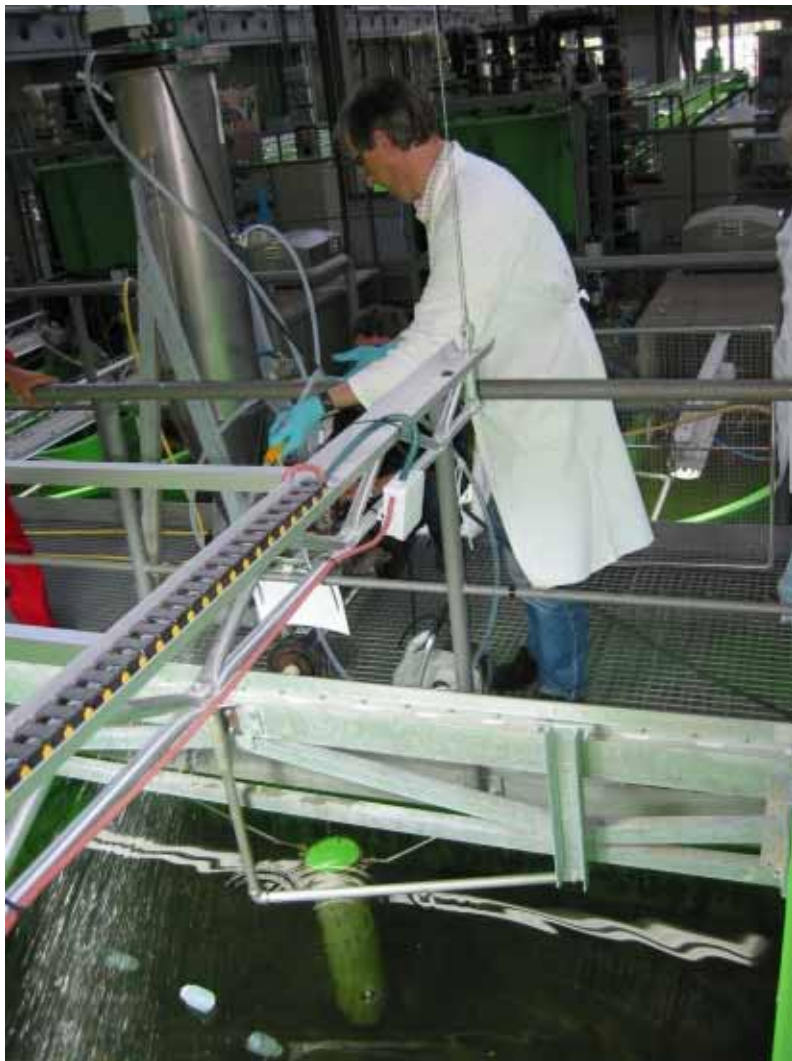
Abb. 8: Applikation von Metazachlor in den Teichen mit einem mobilen Edelstahlmischbehälter (Quelle: Autoren)
