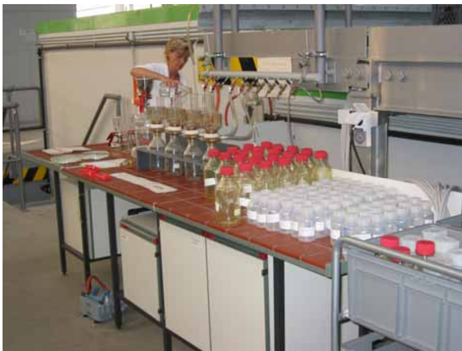
Abb. 17: Filtrationsanlage zur Wasserprobenaufbereitung (Quelle: Autoren)
