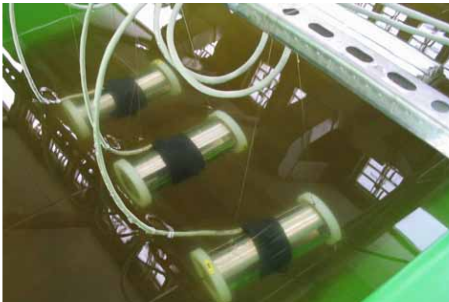
Abb. 21: Messkammern des Multispecies Freshwater Biomonitors in einer Rinne (Quelle: Wermann 2004)
