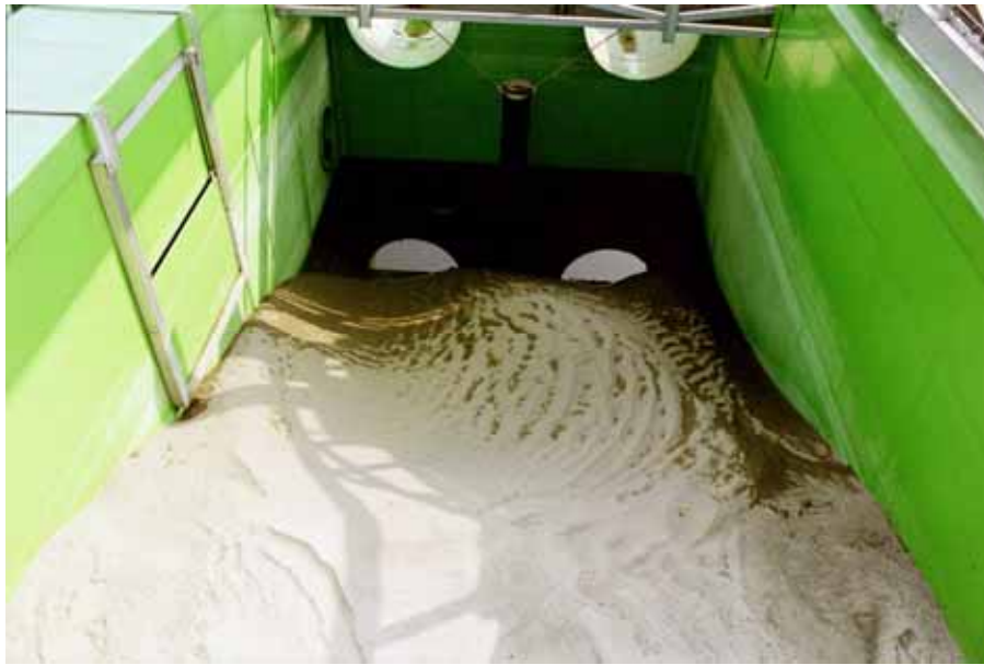
Abb. 57: Kolkbildung in der Uferböschung nach Durchströmung eines Teiches mit 0,4 \text{ m} \cdot \text{s}^{-1} über 24 Stunden (August 2002) (Quelle: Autoren)
