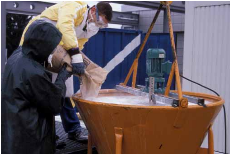
Abb. 14: Herstellen der Kalksteinmehlsuspension in einer speziell umgebauten Bombe (November 2001; Quelle: Autoren)
