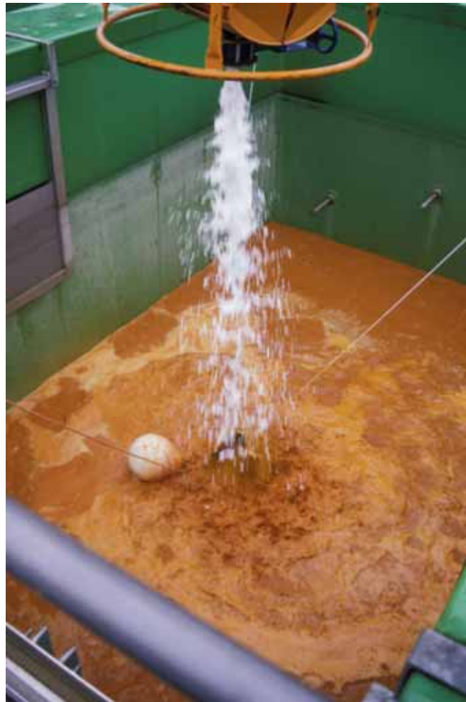
Abb. 15: Ablassen der Kalksteinmehlsuspension in das Mischbecken, Bildung von rötlichbraunem Eisenhydroxid (November 2001; Quelle: Autoren)
