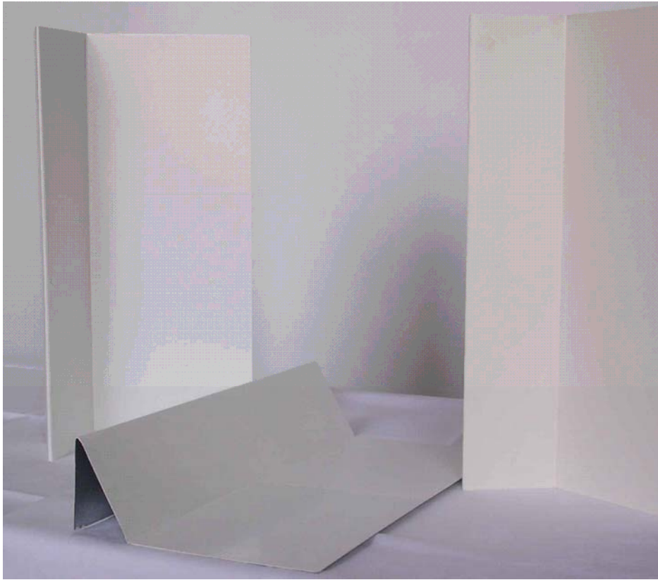
Foto 2: Untergrund Metall; verzinktes Stahlblech
