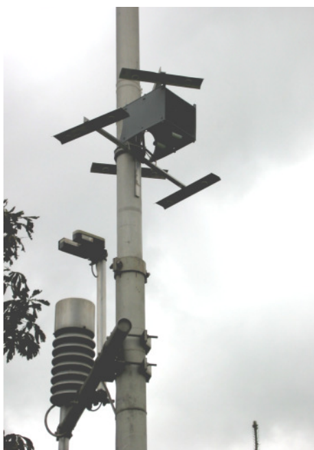
Abbildung 9.1: Messaufbau an der Messstelle Bösel des NLOE mit unterschiedlichen Passiv-Sammlern
