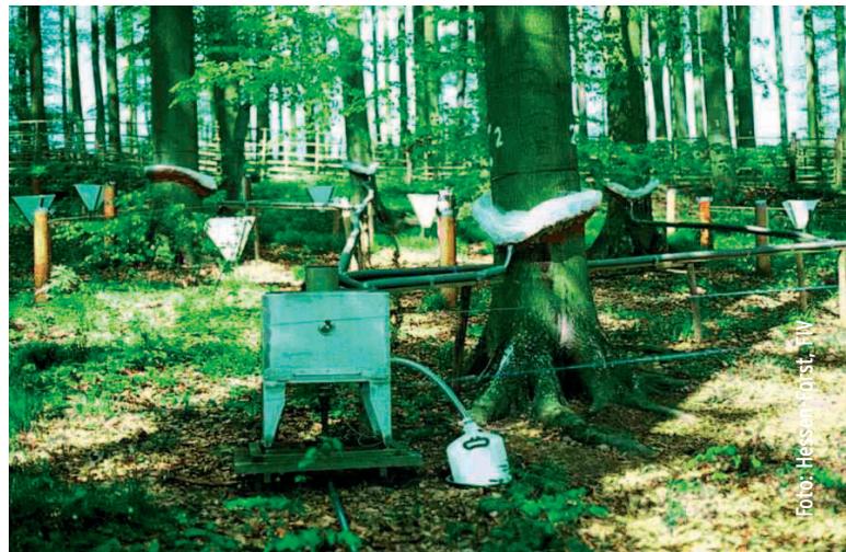
Messstation des europäischen Waldmonitorings.
