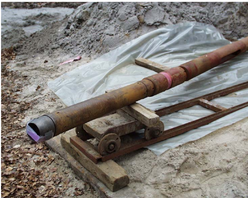
Abb. 5. Rammkernbohrsonde mit Tracer-Beutel am Schneidschuh (Foto: I. Stodian).
