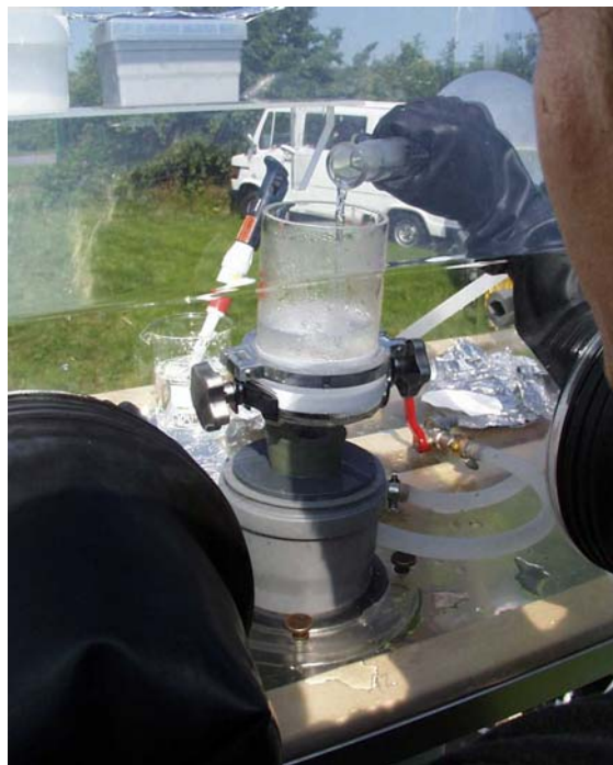
Abb. 17. Filtrationsanlage und Entnahmeverrichtung in einer Glove-Box mit Argonatmosphäre (Fotos: I. Stodian).
