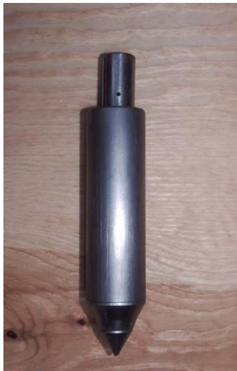
Abb. 7. Drucksonde FROSTAP 35: Sondenspitze (Foto: I. Stodian).
