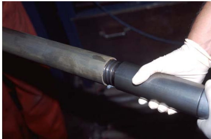
Abb. 10. Drucksonde FROSTAP 35: Zusammenbau der Einheit Sondenspitze / Peltierelement mit dem Gestänge (Foto: I. Stodian).
