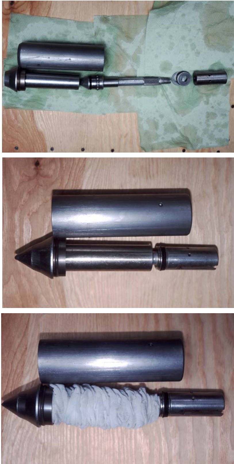
Abb. 8. Drucksonde FROSTAP 35: Sondenspitze in Einzelteilen (Fotos: I. Stodian).
