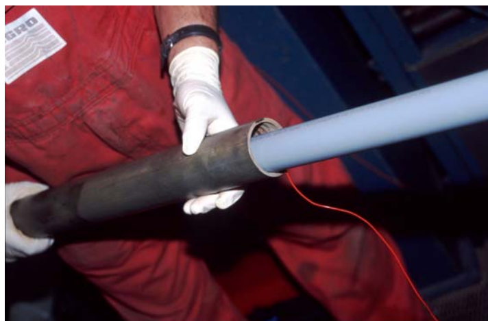
Abb. 11. Drucksonde FROSTAP 35: Gestänge mit Liner und Stromkabel für das Peltierelement (Foto: I. Stodian).
