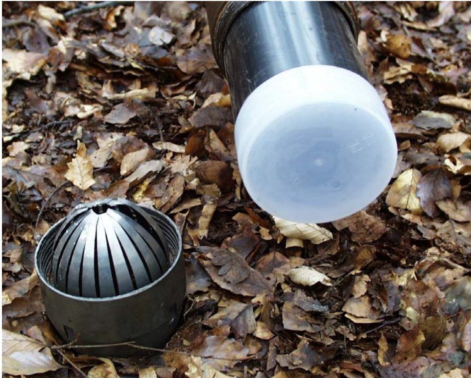
Abb. 4. Liner in der Rammkernbohrsonde (mit Deckel) mit Schneidschuh und Kernfänger (Foto: I. Stodian).
