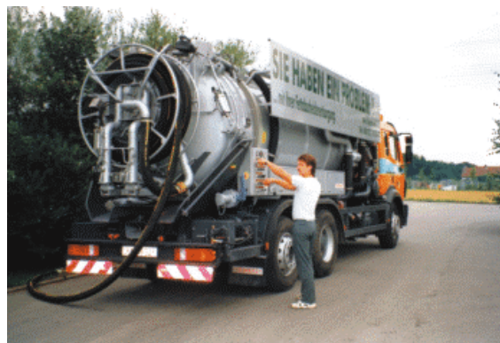
Abbildung 8.6: Schlammsaugwagen zur Entsorgung der Inhalte von Fettabscheidern
