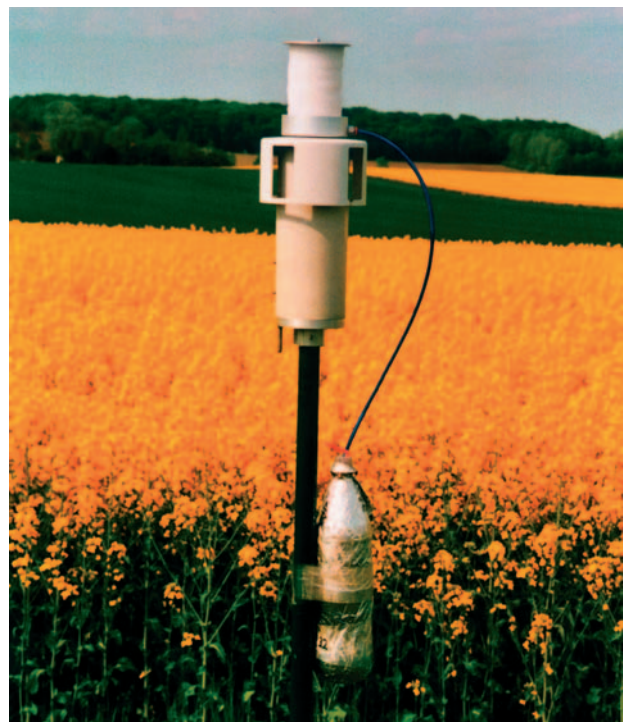
Sigma 2 mit Pollen-Massen-Filter (PMF) für molekularbiologische Analysen des GVP-Eintrags PCR. (Foto: Ökologiebüro Bremen)
