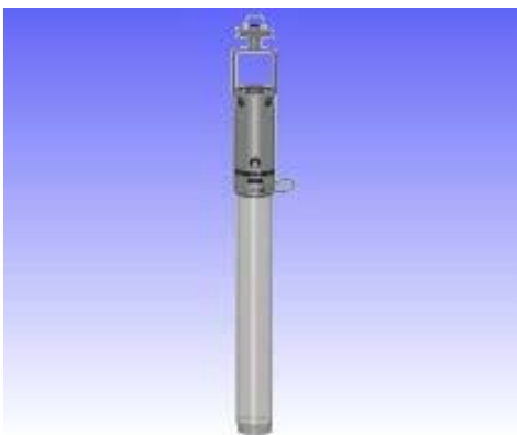
Abbildung 2. Probenahmegeräte: Stechcorer (links) und Ekman-Sedimentgreifer (rechts, Foto: Wasserwirtschaftsamt Landshut)
