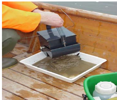
Abbildung 2. Probenahmegeräte: Stechcorer (links) und Ekman-Sedimentgreifer (rechts, Foto: Wasserwirtschaftsamt Landshut)
