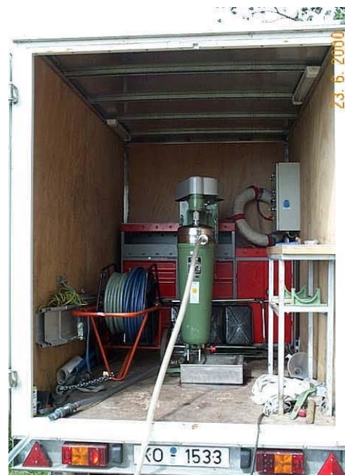
Abb. 3.1: Pkw-Anhänger mit mobiler Durchflusszentrifuge (DZ)
