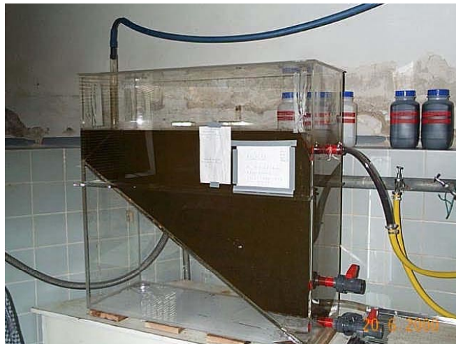
Abb. 3.3: Photo und Schemazeichnung des Sedimentationsbeckens (SB)
