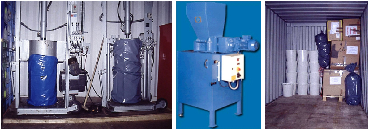
Abb. 6-1 Kompaktoren für Pappen und Kunststoffe, Glas- und Kunststoffschredder, Stauung im Abfallcontainer mit verschließbaren PP-Behältern (alle Bilder N-II)
