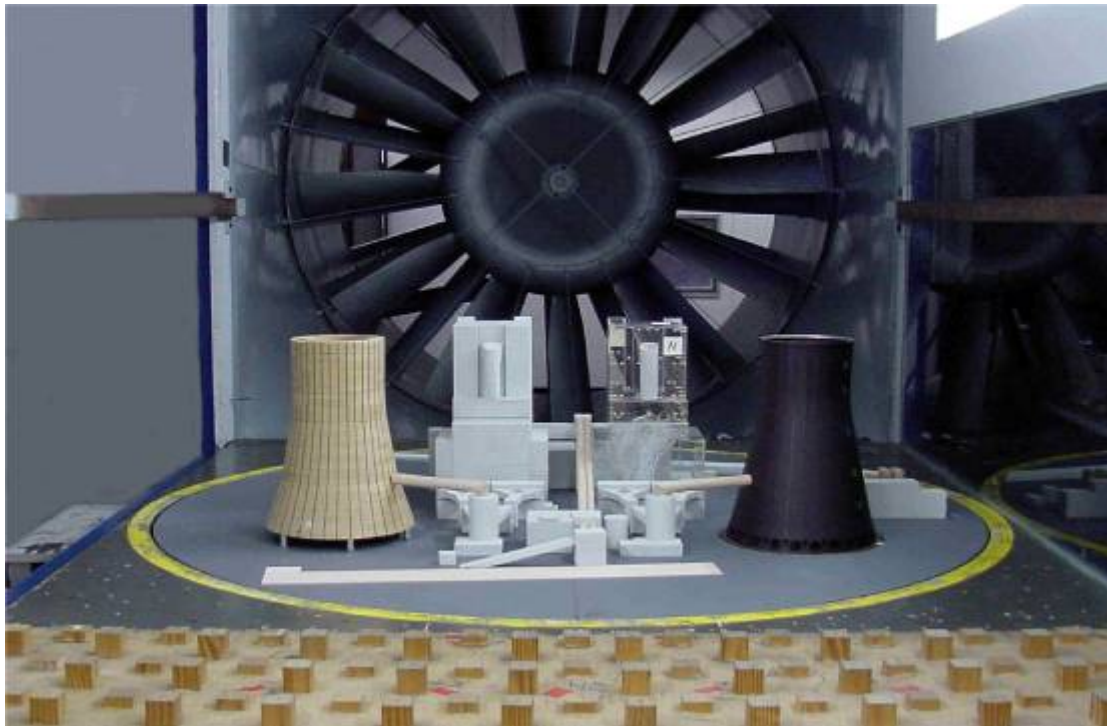
Abbildung 8.7.2.3.1: Grenzschicht-Windkanal mit Kraftwerksmodell, M 1:600
