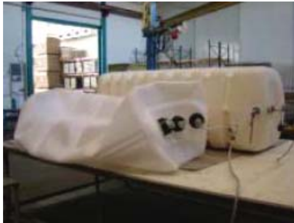
Abbildung 4.3.2: Konventioneller Kunststofftank und hochwassersicherer Tank nach Druckeinwirkung
