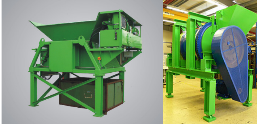
Илл. 12: Установки для предварительной разборки (источник: BRT, MEWA)
