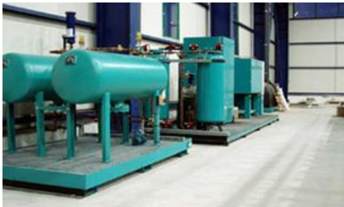
Илл. 9: Установка для сжижения хладагентов (источник: KSR, г. Бохум)
