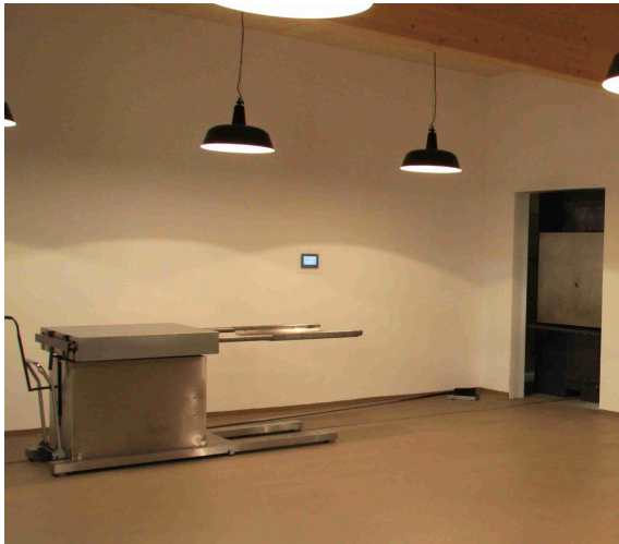
Abbildung 9: Ofenbeschickungsvorrichtungen am Beispiel des Tierkrematoriums Schwäbisch Hall
