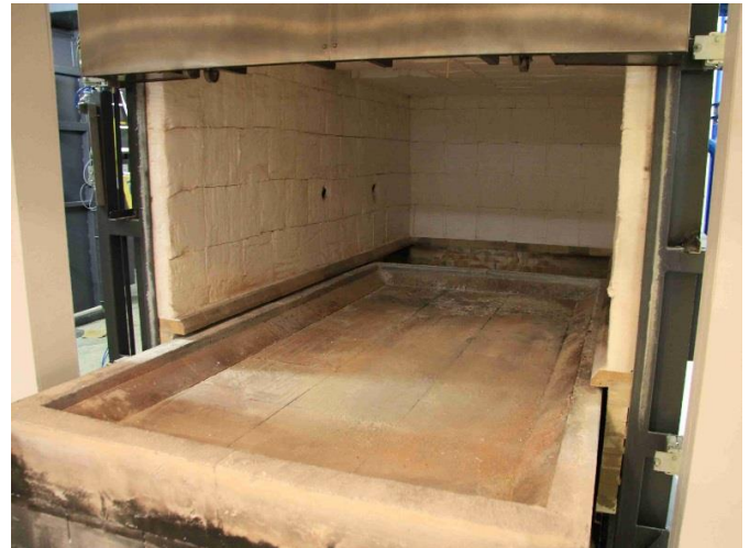
Abbildung 9: Ofenbeschickungsvorrichtungen am Beispiel des Tierkrematoriums Schwäbisch Hall
