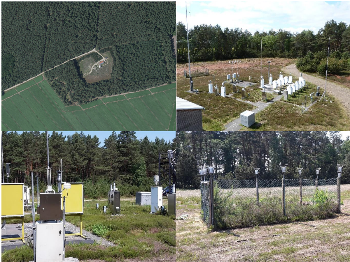
Abbildung 4: Fotos der UBA-Messstation Waldhof und der dort installierten Probenahmegeräte zur Bestimmung von PCDD/F und PCB in Außenluft und Deposition
