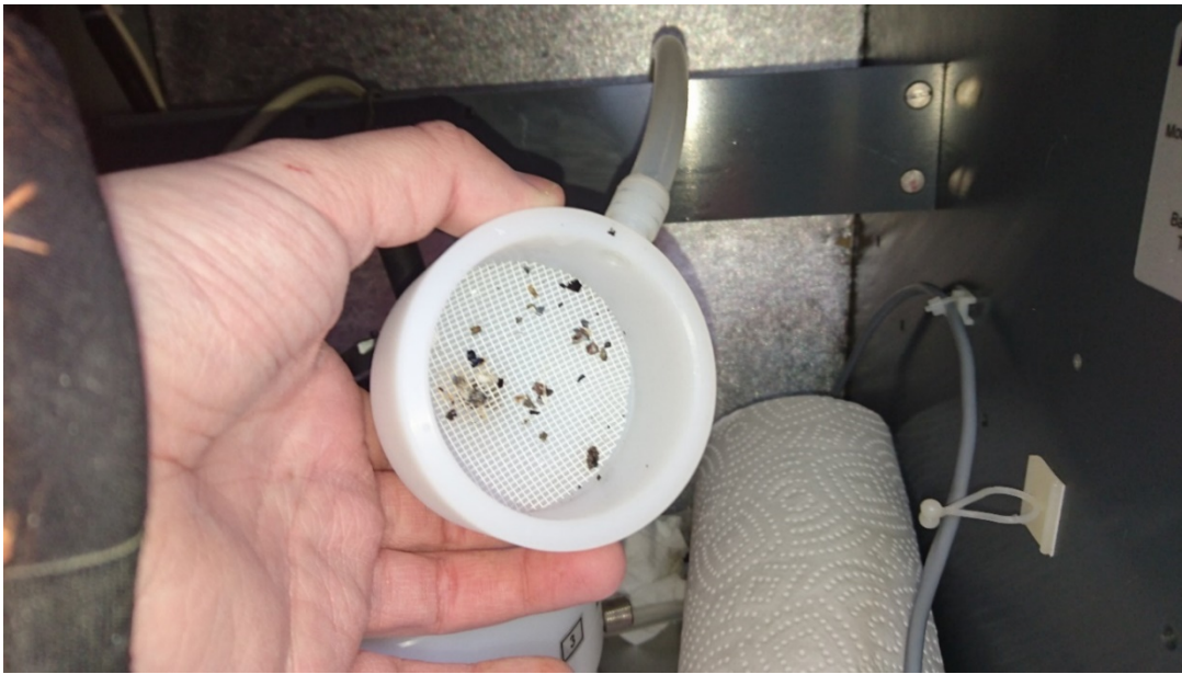
Abbildung 14: Kontamination im Auffangsieb des Probennehmers Arkona Boje
