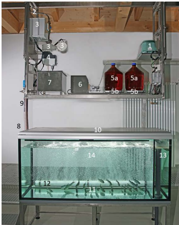
Abbildung 4: Technische Ausstattung der Expositionsaquarien
