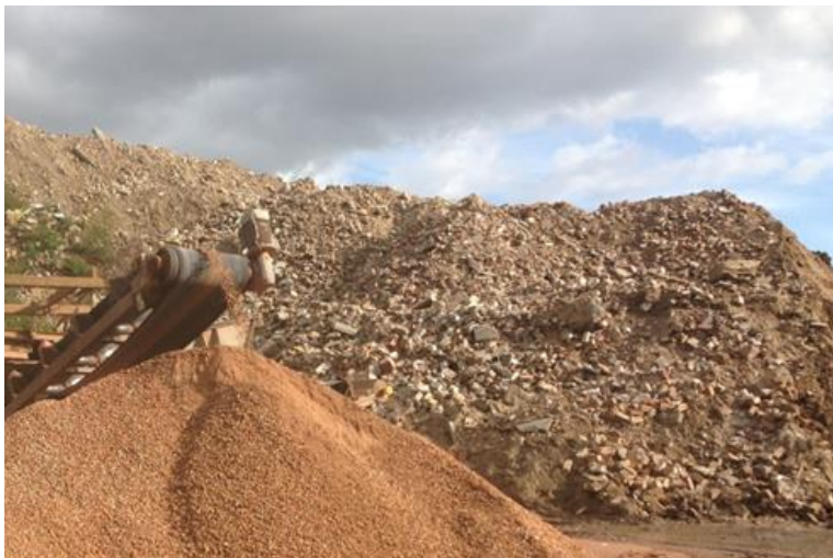
Abbildung 7: Mittels optischer Farbsortierung separiertes Ziegelgranulat (vorne) und dessen Ausgangsmaterial (hinten)
