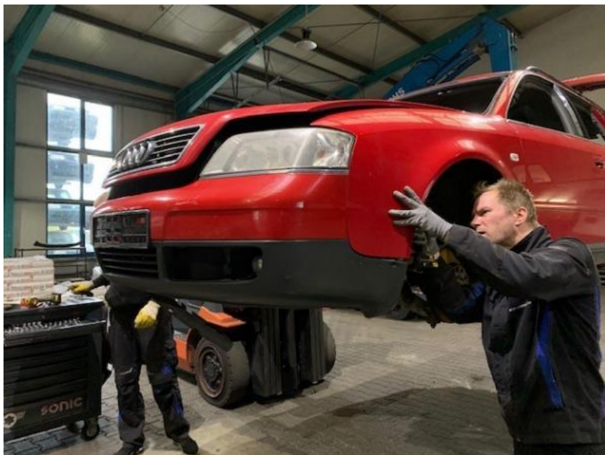
Abbildung 14: Demontage großer Kunststoffteile (1)
