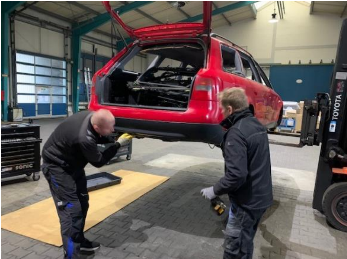
Abbildung 15: Demontage großer Kunststoffteile (2)
