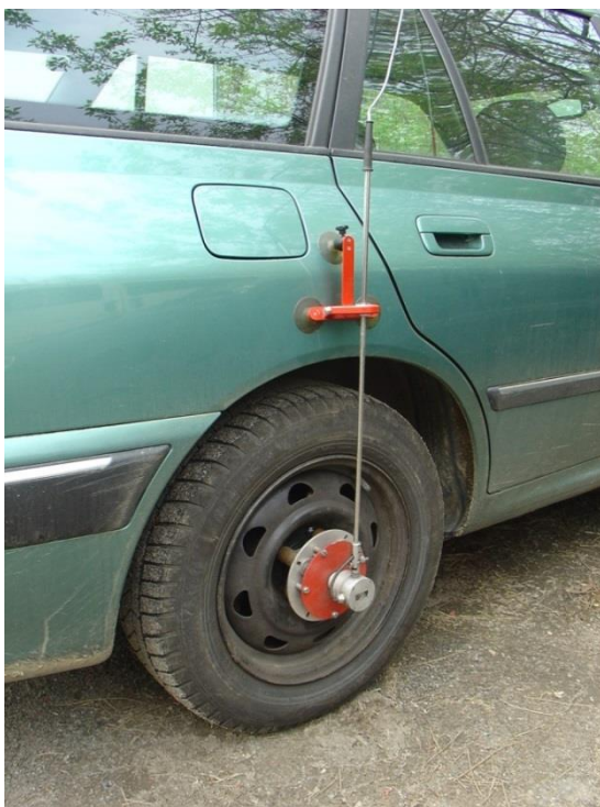
Abbildung 10: Messfahrzeug mit montiertem Peiseler-Messrad
