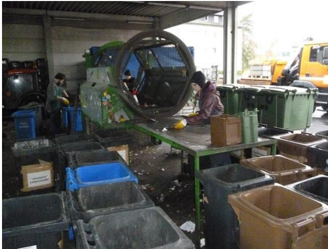
Abbildung 11: Sortierung mittels Trommelsiebmaschine
