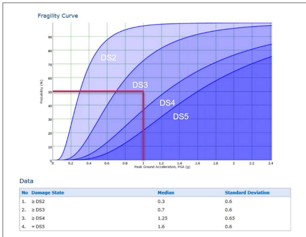
Abbildung 8: Fragilitätskurven für verankerte Stahl tanks
