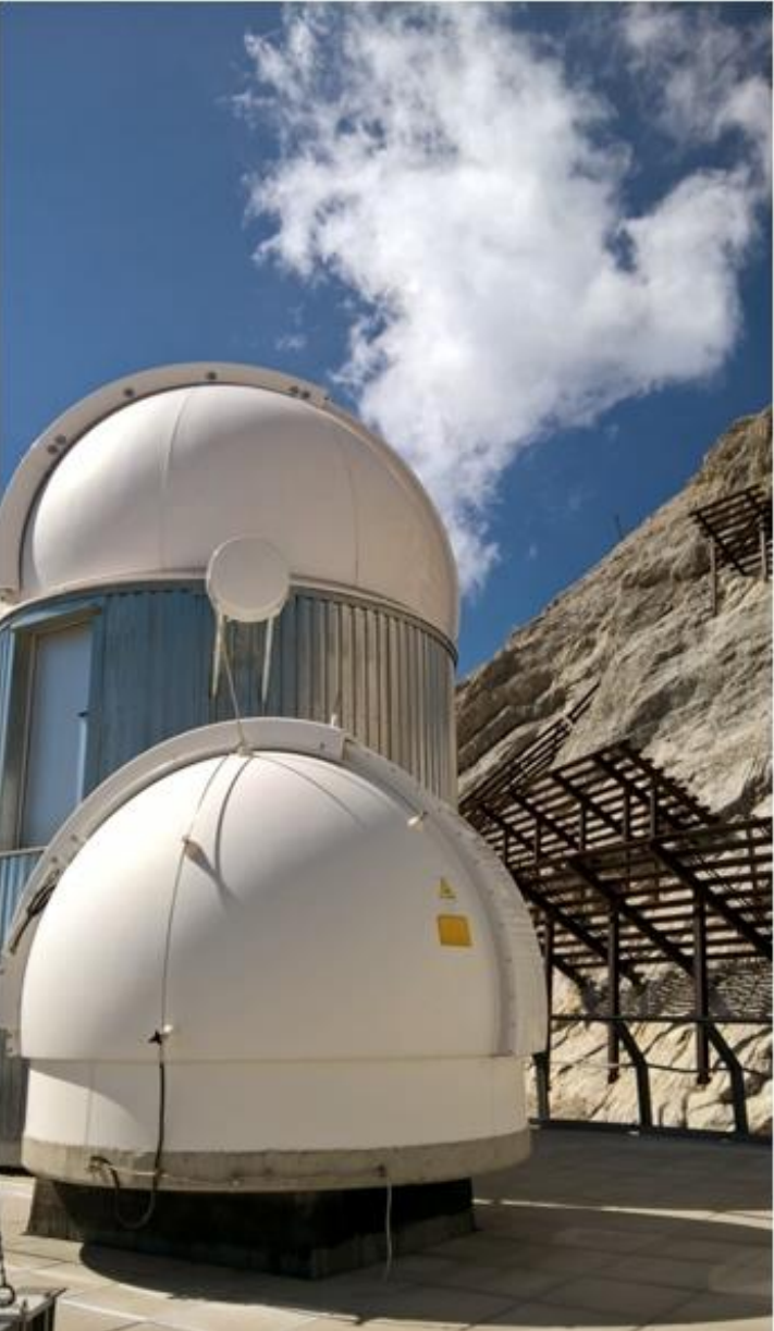
Zwei Lidarsysteme messen an der Umweltforschungsstation höhenaufgelöste Wasserdampfprofile bis in 12 und bis 20km Höhe
