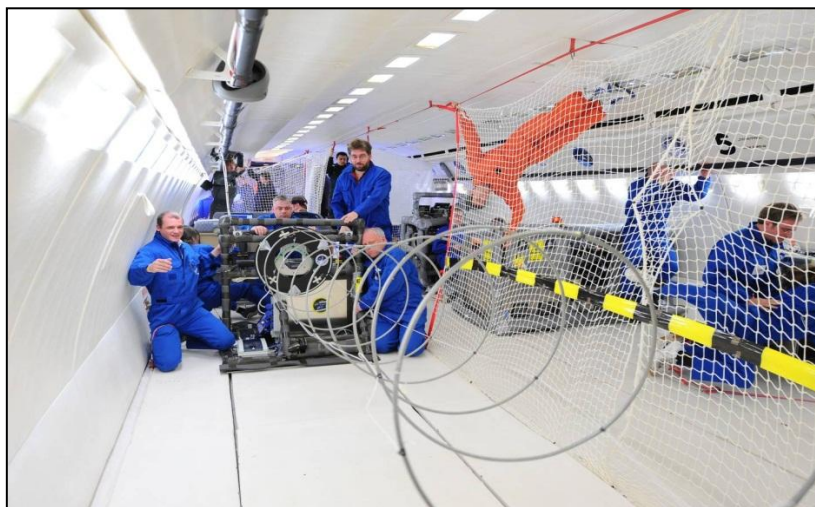
Abbildung 2: Entfaltete Antenne während des Parabelfluges
