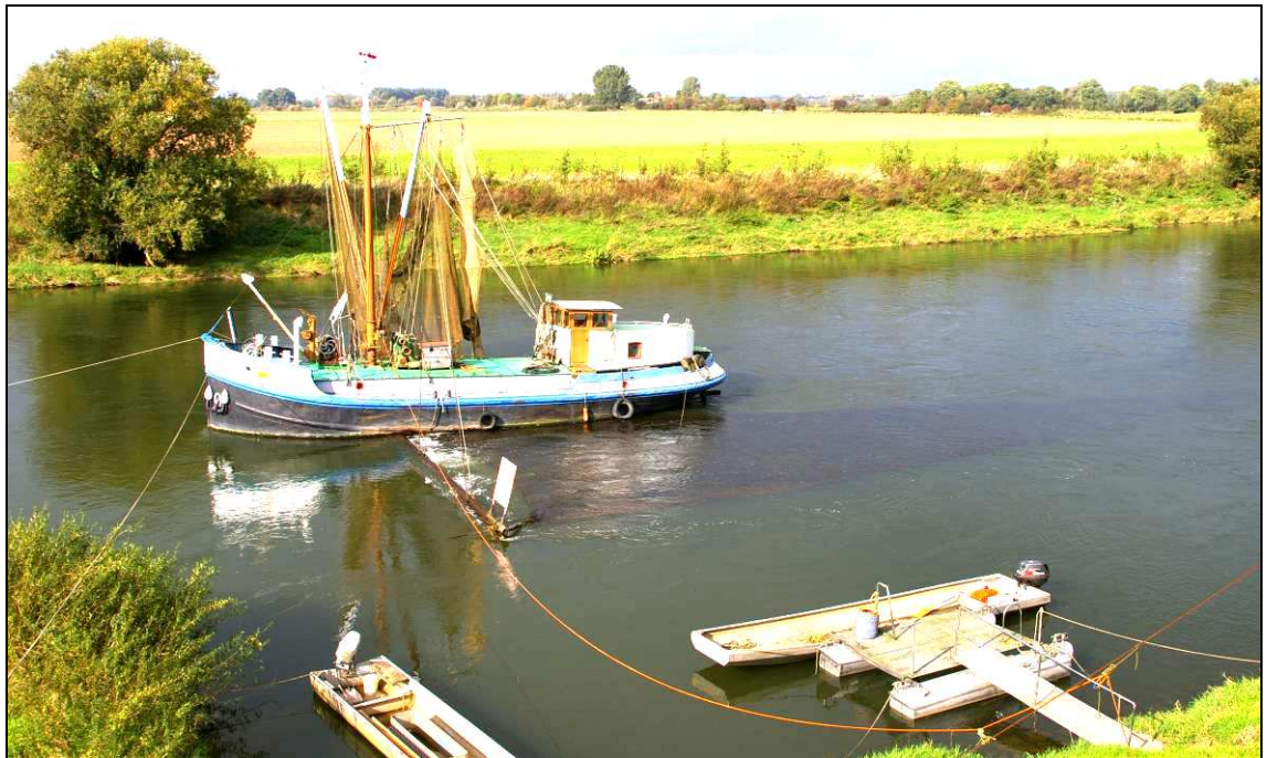
Abb. 4: Schokker des Fischereibetriebs Dobberschütz von der Seite, der Hamen ist als dunkler Schatten seitlich neben und hinter dem Rumpf erkennbar
