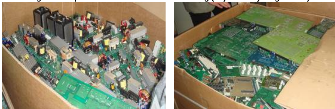
Abbildung 8: Leiterplattenfraktion vor der Entstückung (Fujitsu Recycling Center)
