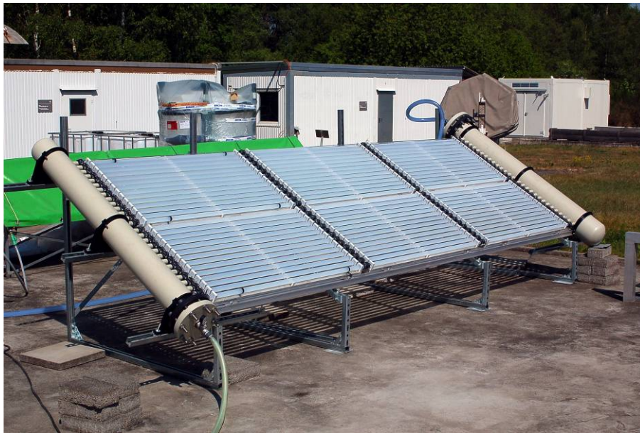
Abbildung 13: Solare Wasserreinigungsanlage (Prototyp 7,4 m 2 ), DLR Köln
