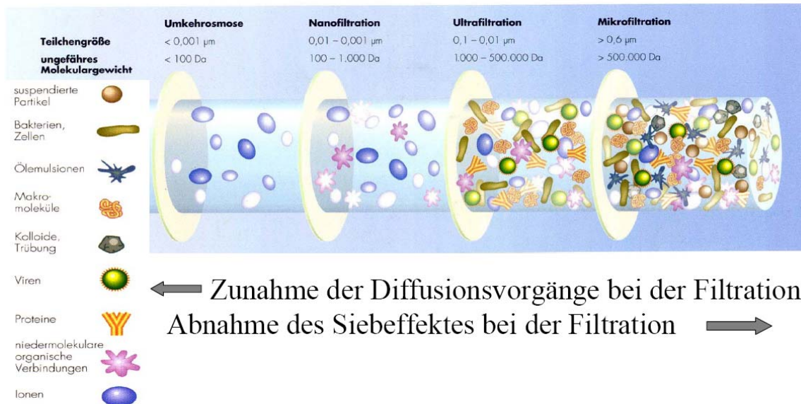
Abbildung 2: Trennbereiche von Membranen - Teilchengrößen und Molekulargewicht für die Mikro-, Ultra-, Nanofiltration und Umkehrosmose (EnTec /8/)
