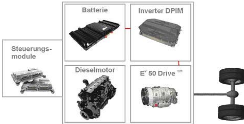
Abbildung 29: Schematische Darstellung des Hybridantriebs 78
