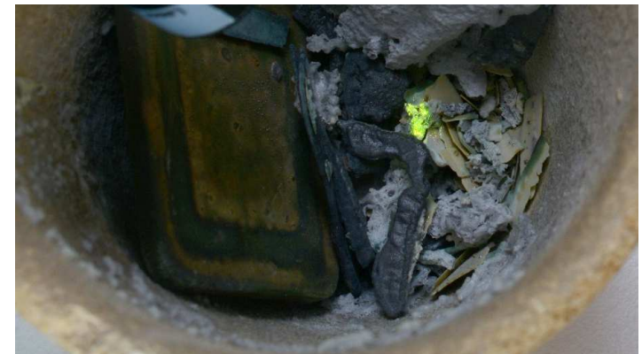
Fluoreszenzmarker nach Veraschung mit OBO-Schalter
