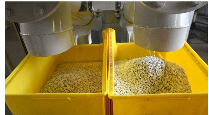
PVC-Mahlgut, sortiert nach Fluoreszenzmarkierung
