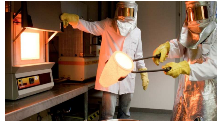
Ausgießen eines glaskeramischen Markers bei Polysecure
