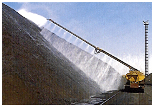
Abbildung 4.20: Gleichmäßiges Besprühen ist extrem wichtig für die Ausbildung einer geeigneten Kruste [134, Corus, 1995]
