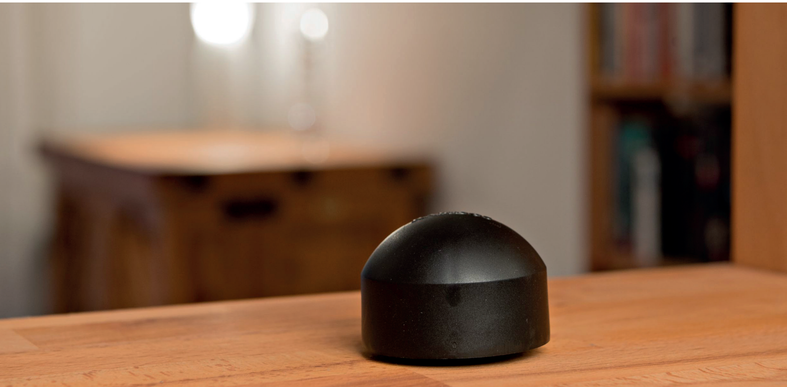
Kernspurdetektor zur Messung der Radon- konzentration. Quelle: BfS.
