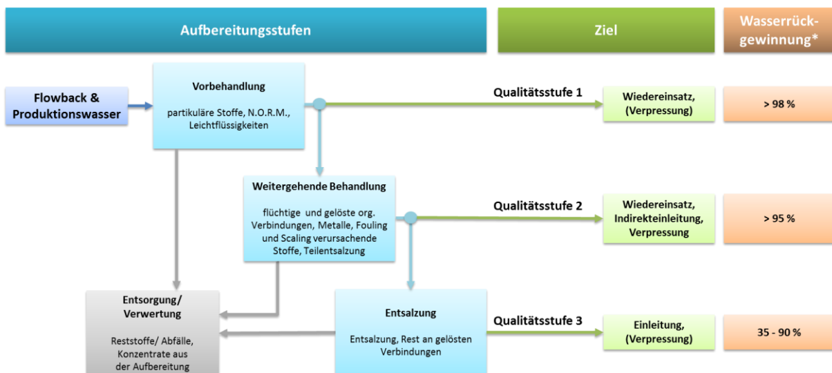
Abb. 4: Auswahl der Flowback- und Produktionswasseraufbereitungsstufen entsprechend den Verwertungs- und Entsorgungszielen
